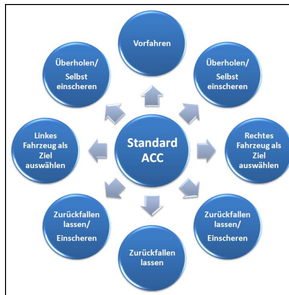
Abbildung 1: Funktionsbelegung des 9-Positionen-Bedienelements
