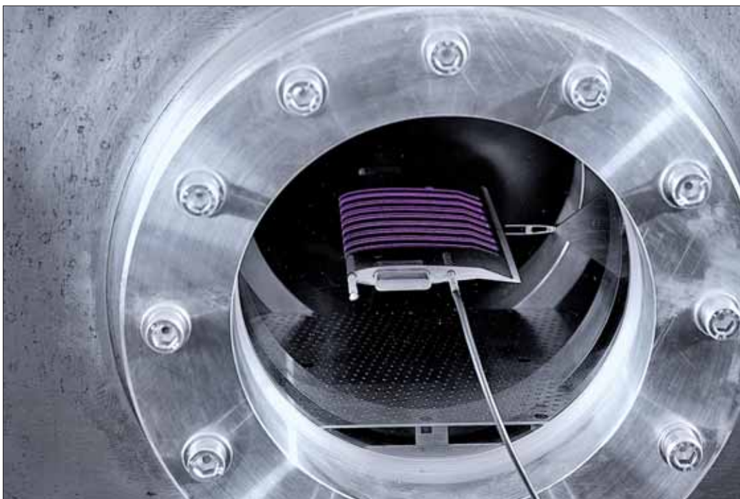
Abbildung 3 Flügel-Profil mit Plasma-Aktuator Array.
