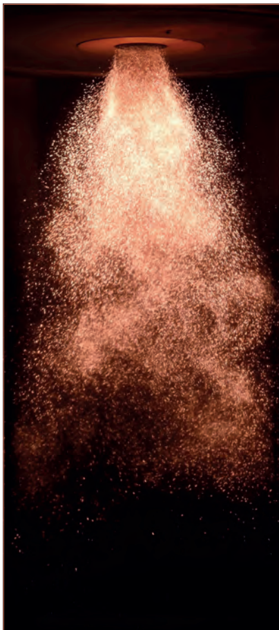
Abb. 2 Eisen kann ähnlich wie Kohle verbrannt werden. Dabei entsteht mit heller Flamme Eisenoxid und Wärmeenergie wird frei Quelle des Bildes: Janik Hebel/Clean Circles
