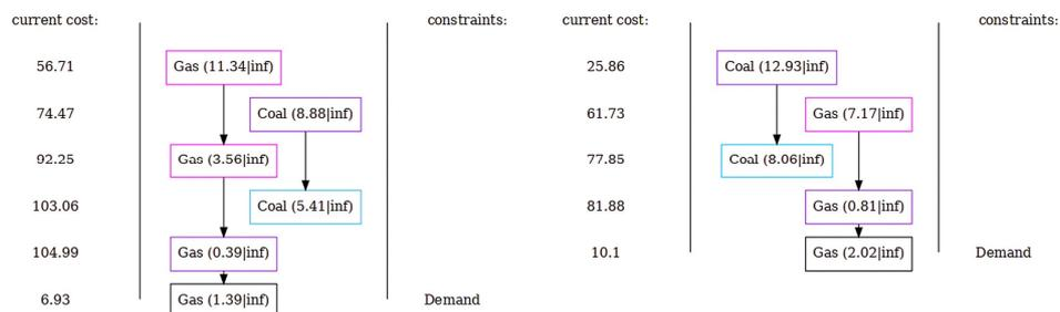
Abbildung 5: Lösungsgraphen für zwei Szenarien eines simplen Energiesystems mit Gas und Kohle. Das Modell soll die Kosten zur Deckung einer fixen Last minimieren und ein CO<sub>2</sub>-Budget einhalten. In Szenario 1 (Kohle ist günstiger, emittiert aber mehr CO<sub>2</sub>) wird Gas als erstes gewählt, in Szenario 2 (Gaskraftwerk emittiert weniger CO<sub>2</sub> als in Szenario 1) wird Kohle gewählt, da das CO<sub>2</sub>-Budget einfacher einzuhalten ist.
