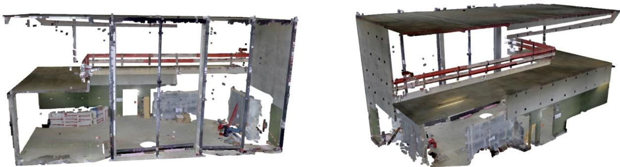
*Abbildung 9: Zwei Perspektiven einer Punktwolke eines Gebäudes im Bau mit einem enthaltenen Türdurchbruch. (Quelle: TU Darmstadt)*
