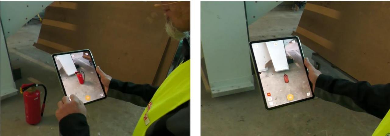
Abbildung 10: Automatische Erkennung und Verortung eines Objektes in der AR-App des digitalen Bauassistenten. (Quelle: DeepSpaceBIM Konsortium / Robotic Eyes)
