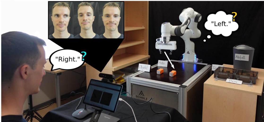
Abbildung 3: Übersicht des Experiment-Setups mit Roboter, um teils suboptimale menschliche Angaben in einem RL-Algorithmus zum Lernen zu nutzen [P1].
