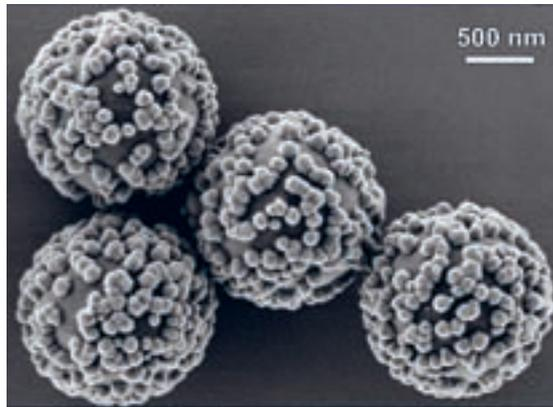
Polymer-Silica-Teilchen unter dem Rasterelektronenmikroskop.
