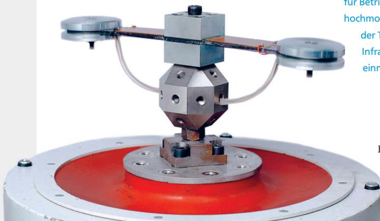
Experiment zum Dämpfen von Schwingungen.
