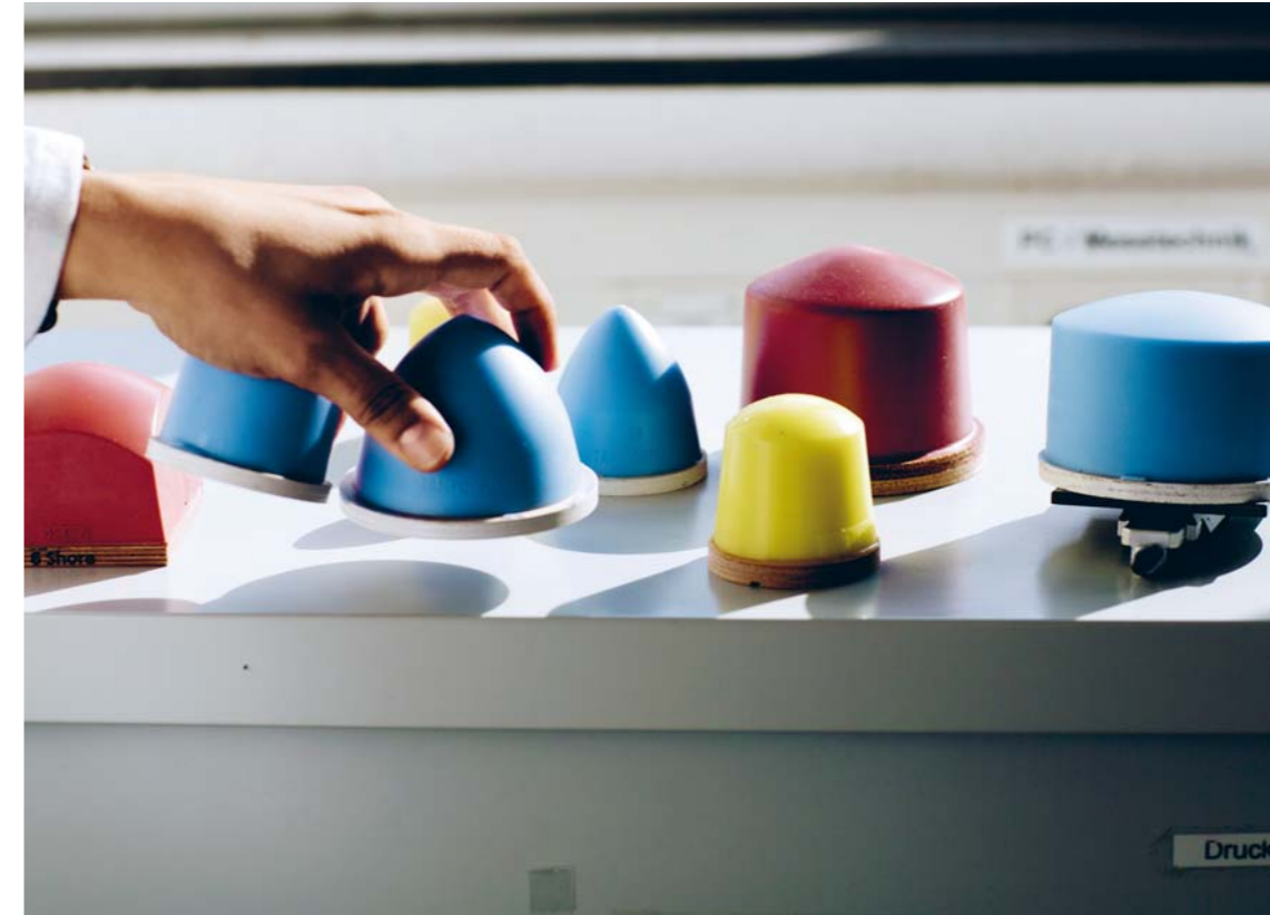
Mit Drucktampons werden Leuchtsymbol-Schichten auf dreidimensionale Oberflächen übertragen.
