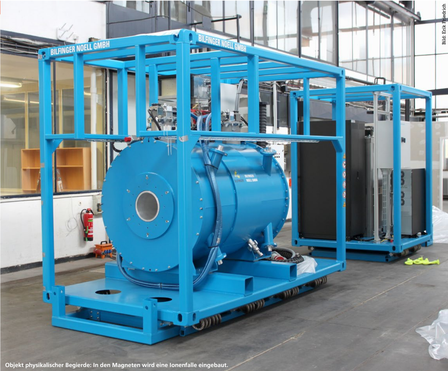
Objekt physikalischer Begierde: In den Magneten wird eine Ionenfalle eingebaut.
