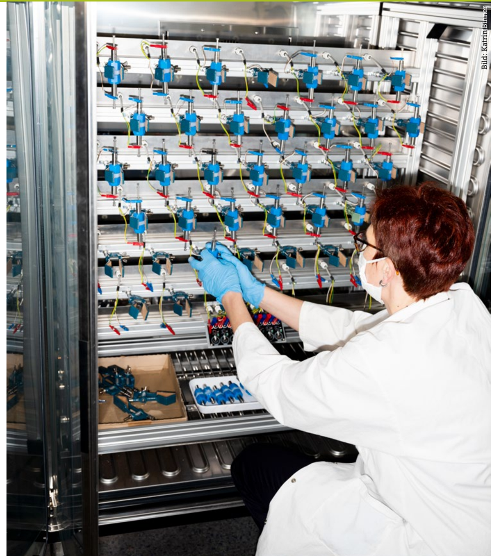
Klimatisierte Teststation für elektrochemische Untersuchungen: Die Elektroden in den blauen Zellen bestehen aus neuartigen Batteriematerialien.
