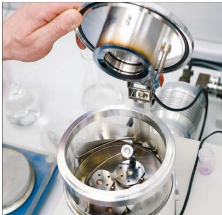
Sputteranlage für die Probenpräparation.
