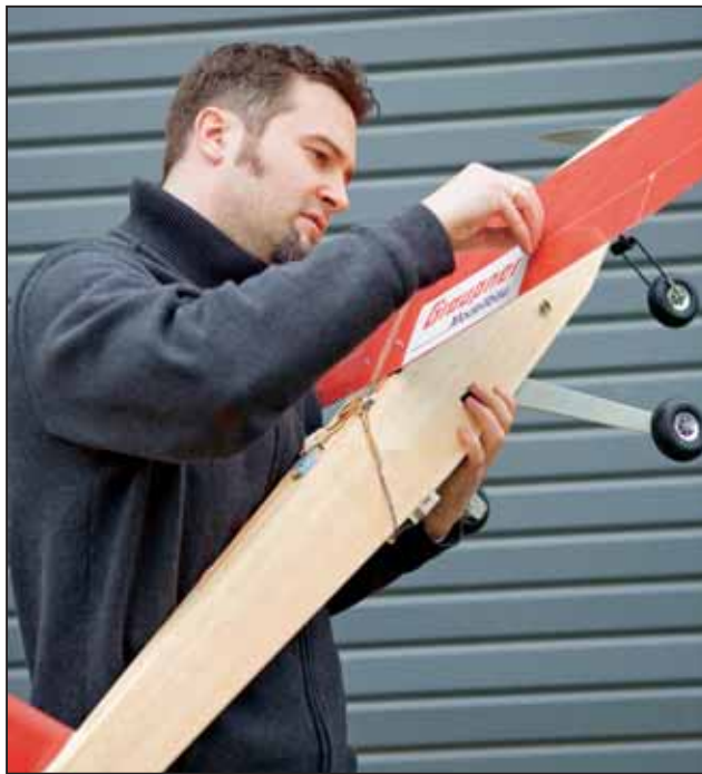
Sven Grundmann klebt die Tragflächen seines Modellflugzeugs mit Plasma-Aktuatoren für einen besseren Auftrieb.
