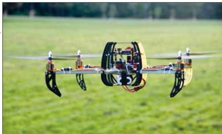
Mehr Sicherheit in der Luft: Informatiker der TU Darmstadt statteten diesen Quadrocopter mit einem neuen verschlüsselten Kommunikationsmodul aus.
