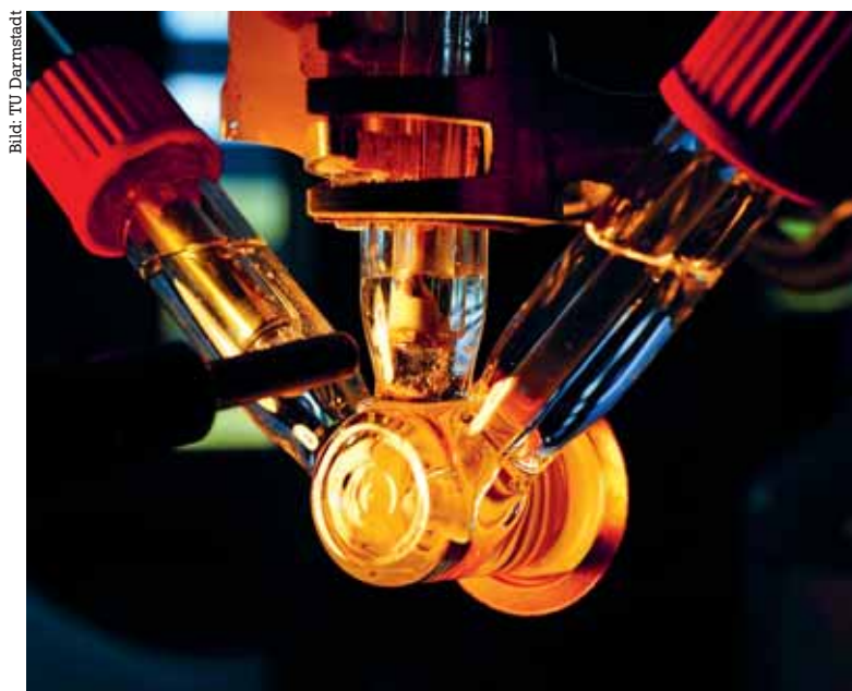
Beleuchtete Fotokathode: Forscher wollen durch lichtgetriebene Wasserspaltung Brennstoffe auf regenerative Weise erzeugen.
