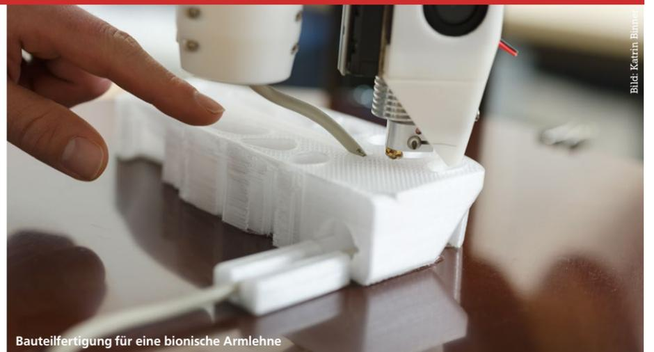
Bauteilfertigung für eine bionische Armlehne
