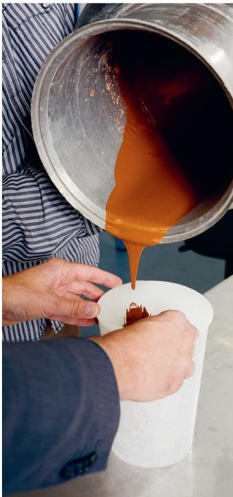
Geopolymerbeton fließt in eine Schalung (oben), ausgehärteter Probekörper (unten).
