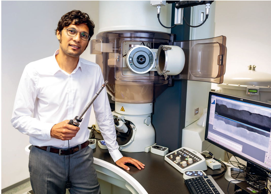
Dr. Leopoldo Molina-Luna am Transmissionselektronenmikroskop mit geöffneter Schleuse zum Einführen des „Labors“ (vergrößert im Bild unten links gezeigt).
