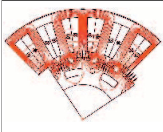
Abbildung 3: Numerische Feldberechnung als modernes Entwicklungstool zur Berechnung hoch ausgenutzter PM-Synchronmotoren mit Zahnspulenwicklung (Quelle: TU Darmstadt)
