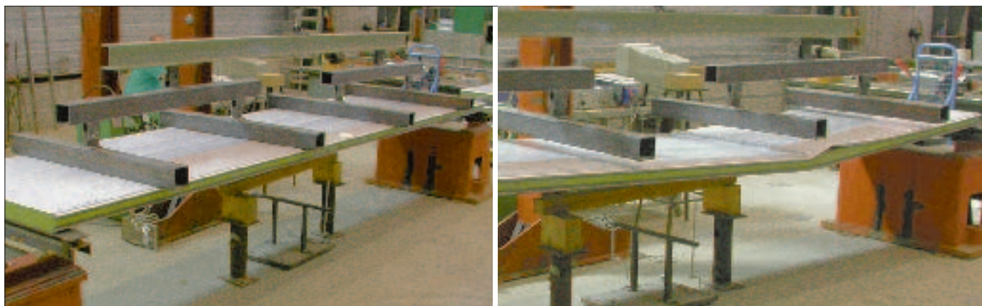
Bild 5: Einfeldträgerversuch: Versuchsaufbau (links), Versagen durch Knittern des oberen Deckblechs (rechts) Test on simply supported panel (left), failure due to wrinkling (right)
