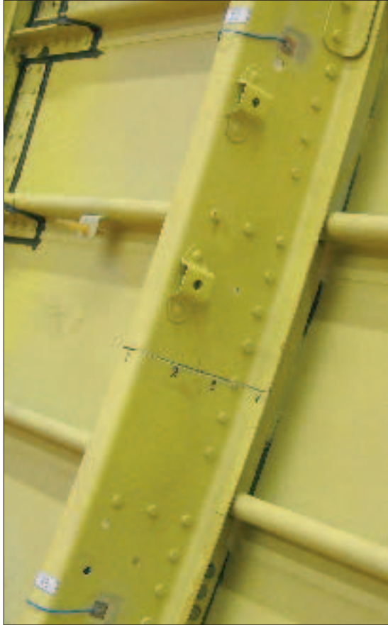
Bild 2 Riss (mitte) in einem Querträger und Applikation eines piezoelektrischen Aktors (oben) und eines piezoelektrischen Sensors (unten) (TU Darmstadt SzM, Fraunhofer LBF)
