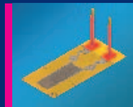
Prinzipieller Aufbau des Dehnungsmessstreifens (DMS) für die Strukturintegration
