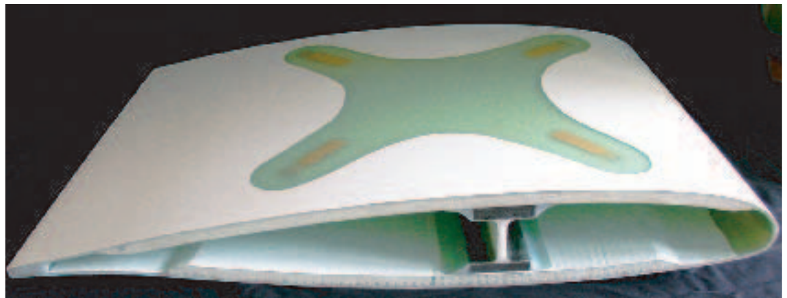
Bild 5 Flügelmodell mit strukturintegrierten Piezofasermodulen (Fraunhofer LBF, ISC, IzFP, Degussa Röhm, Hochschule Darmstadt) Wing demonstrator with integrated piezoelectrical fibers
