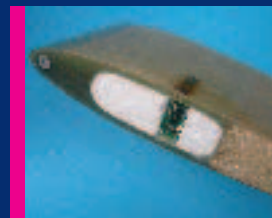
Anwendungsbeispiel: Rotorblatt mit integriertem DMS und kundenspezifischer Elektronik
