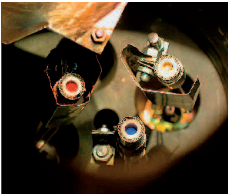
Abb. 9 Verdampferquellen für die Kodeposition der Halbleitermatrix ZnSe (gelb) und der beiden Pigmente F_{16} ZnPc (blau) und PTCDA (rot). Evaporation sources of the semiconductor matrix ZnSe (yellow) and the two pigments F_{16} ZnPc (blue) and PTCDA (red) combined on a flange for codeposition.
