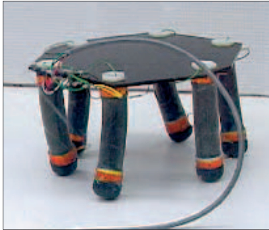
Abb. 6 (a) Künstlicher Muskel mit Feder, (b) laufender Roboter Quelle: SRI International (a) Artificial muscle with spring, (b) walking robot
