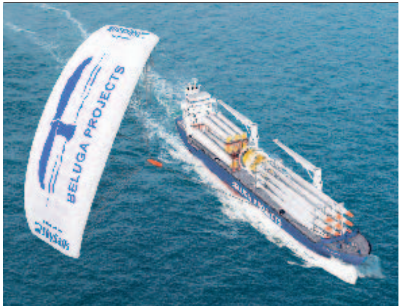
Abb. 1 Zugdrache spart Treibstoff und schont die Umwelt: Schwergut- schiff „Beluga SkySails“ im Praxistest; www.skysails.info
