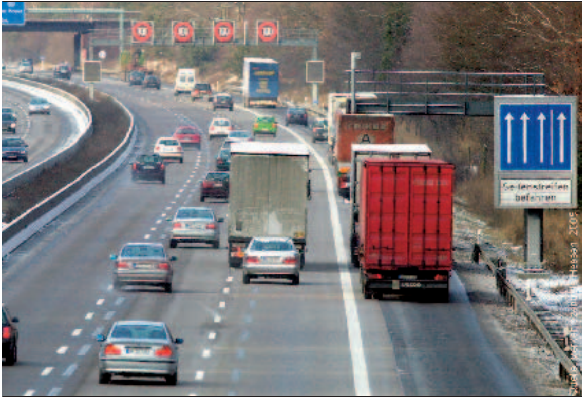
Abb. 2 Flexible Infrastrukturnutzung durch dynamische Seitenstreifenfreigabe Adjusting infrastructure flexibly by dynamic shoulder use
