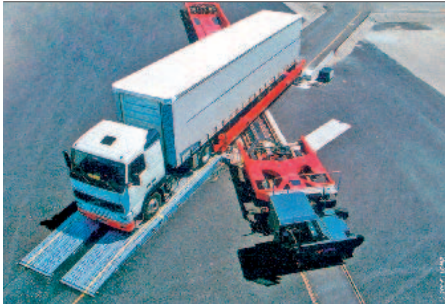
Abb. 3 Innovative Umschlag- systeme: MODALOHR Taschenwagen für den Umschlag von Standard Sattelaufliegern; www.modalohr.com
