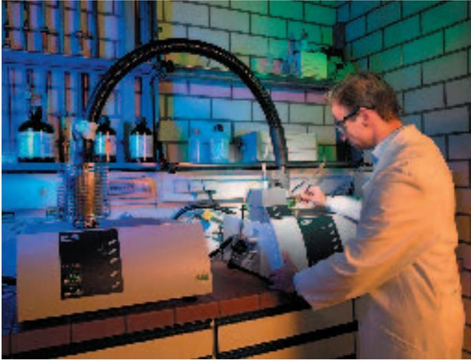
Mittels der Thermogravimetrie-Massenspektrometrie (TG-MS) können die Materialeigenschaften analytisch bestimmt werden.
