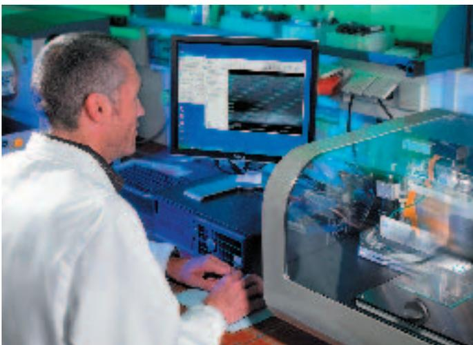
Der Bedruckbarkeitstest mit einem Tintenstrahldrucker zeigt, ob sich das Konzept auch bei der Massenbedruckung in der Praxis anwenden lässt.
