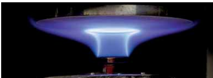
Abbildung 3 Anhand von idealisierten Modellsystemen werden Austauschprozesse von Energie, Masse und Impuls zwischen gasförmiger Strömung und Wand untersucht. Die Fotografie zeigt beispielhaft eine Gasflamme, die in ihrem oberen Teil mit einer gekühlten Metalloberfläche in Wechselwirkung steht.
