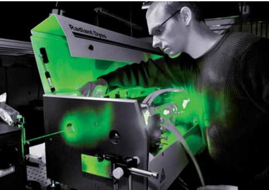
Abbildung 2 Eine exakte Justage optischer Systeme ist vor jeder Messung notwendig.
