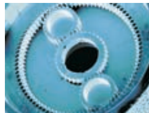
Abbildung 1 Mit UV-Lithographie und Galvanoformung gefertigte Zahnräder in einem Micro Harmonic Drive® Getriebe (Micromotion GmbH, Mainz).
