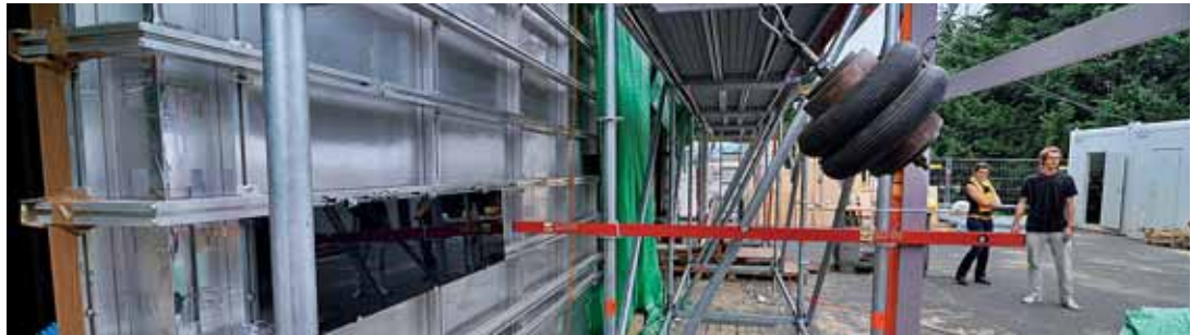
Abbildung 4 Versuchsaufbau für den vom IWMB durchgeführten Pendelschlagversuch mit einem Doppelreifen-Pendelkörper, hier für eine Fallhöhe von 45 cm.
