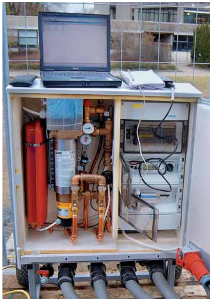
Abbildung 4 Messeinrichtung zur Durchführung eines Geothermal Response Tests zur Bestimmung der Wärmeleitfähigkeit des Untergrundes und des thermischen Bohrlochwiderstandes.
