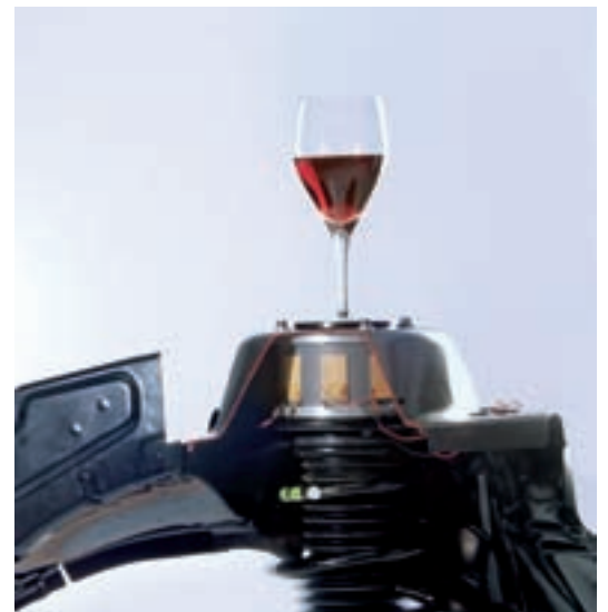
Abbildung 3 Aktives Interface zwischen PKW-Federbein und Karosserie.
