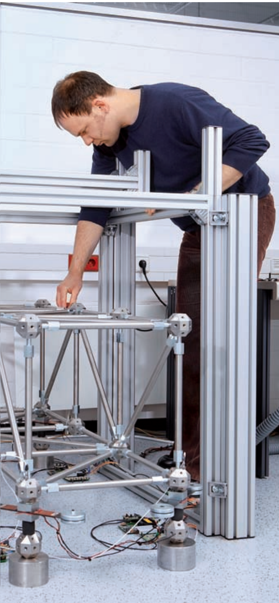
Tragwerk mit verteilten adaptiven Tilgern zur Schwingungskompensation.
