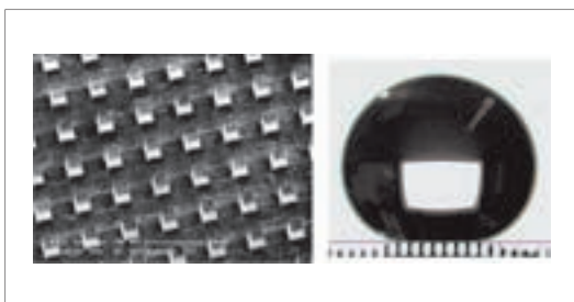
Abbildung 3 Durch Ultrapräzi- sionszerspanung erzeugte superhydrophobe Oberfläche (links) und Seitenansicht eines Wasser- tropfens auf einer derartigen Oberfläche (rechts).
